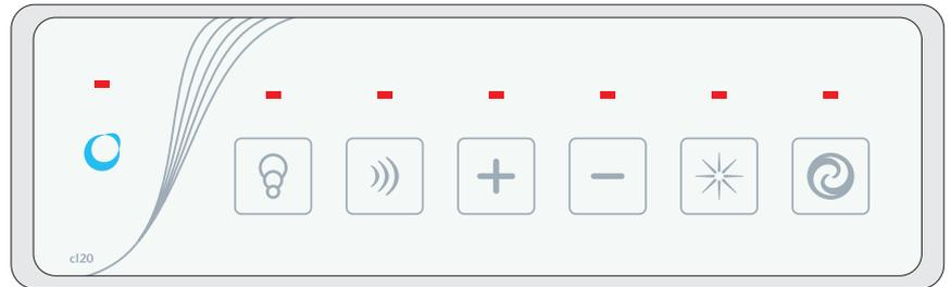
**Grundfunktion:** Wird Spannung am System angelegt, oder im Ruhezustand eine Taste gedrückt, blinkt die grüne Netz-LED im Abstand von 5 Sekunden kurz auf. Dies geschieht für 20 Min. Leuchtet die grüne LED durchgehend, ist das System betriebsbereit. Wenn ein Trockenlaufschutz installiert ist, muss erst genügend Wasser in der Wanne vorhanden sein.
